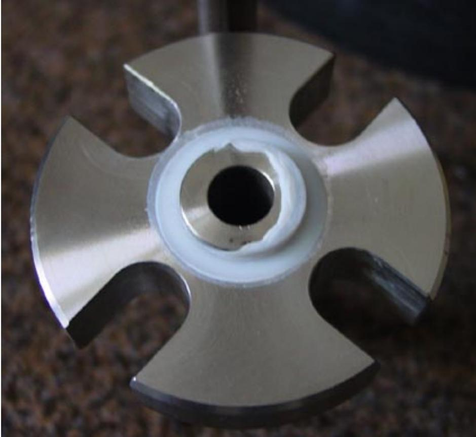
**Bild 2:** Ventilblöcke mit PTFE-Dichtungen sind beim Einsatz unter hohen Temperaturen deutlich im Nachteil: Der Kunststoff wird bei großer Hitze sehr weich, weshalb der Druck des Prozessmediums ihn in verfügbare Hohlräume presst.
