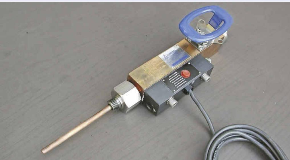
*Die beheizbare Entnahmesonde besteht aus einem Kupferblock mit Wärmeträgerrohr, einem angeschraubten Heizblock und einem integrierten Kugelhahn*
