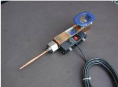
**Bild 1:** Die beheizbare Entnahmesonde besteht aus einem Kupferblock mit Wärmeträgerrohr, einem angeschraubten Heizblock und einem integrierten Kugelhahn.
