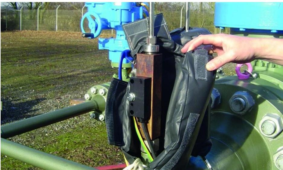
**Bild 2:** AS-Schneider hat die erheizbare Entnahmesonde kompakt konstruiert. Sie ist dadurch einfach zu montieren.
