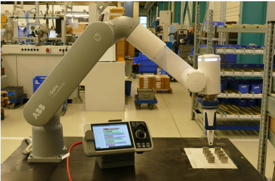
**Bild 1+2:** Kollaborative Roboter (Cobots), getestet in der Montage bei AS-Schneider.
