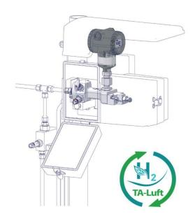
**Bild 1:** Der SB-Ventilblock erfüllt standardmäßig die Dichtheitsklasse B für flüchtige Emissionen nach ISO 15848-1, sowie die TA-Luft Novelle aus 2021.
