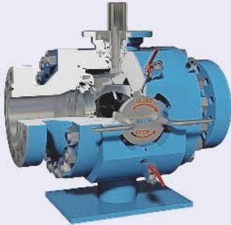
dung als Absperrarmatur dient der Hartmann-Molchkugelhahn als Aufgabe- oder Entnahmearmatur für Molche. Durch eine seitlich integrierte Schleuse, die durch ein Bajonettsystem verriegelt und gesichert ist, können Molche einfach, schnell und sicher aufgegeben oder entnommen werden. Ein optionaler Bypass in der Geschlossenstellung
